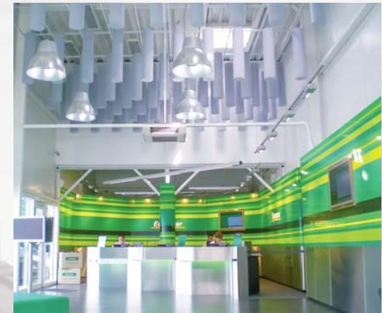
Kombination von Beleuchtung und vertikalen Akustik-Zylindern
