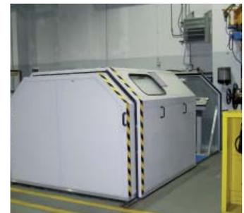
Kapsel - seitlich auf Laufschienen, verfahrbar auf Dach-/Wandelement.
