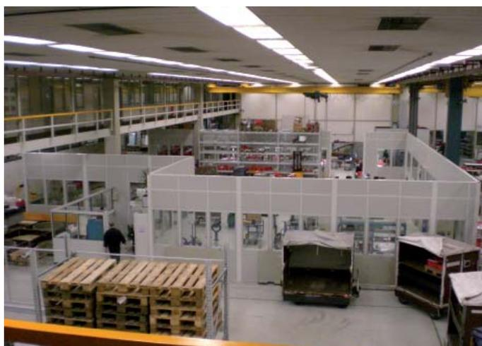
Lärmschutzwände in Modulbauweise.
