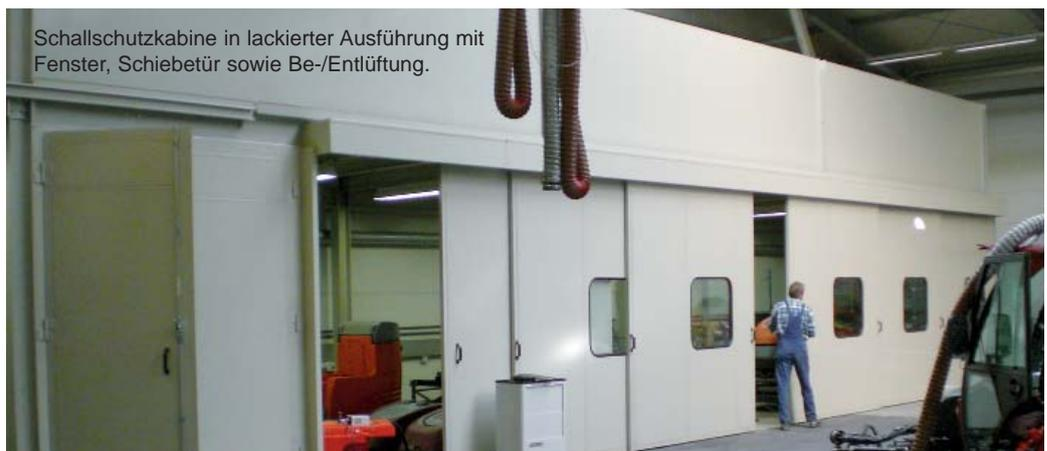
Schallschutzkapsel in lackierter Ausführung mit Fenster, Schiebetür sowie Be-/Entlüftung.
