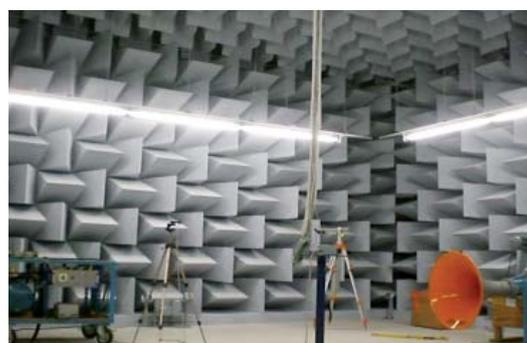
Reflexionsarmer Raum mit illsonic® Keilen ausgekleidet. Die Keile sind demontierbar an Drahtspitzen aufgesetzt. Das Material ist schwerentflammbar nach DIN 4102 B1, faserfrei und hat einen hohen Lichtreflexionsgrad. Hier können nach DIN EN ISO 3745 Geräuschmessungen und Schalleistungsmessungen nach dem Hüllflächenverfahren mit einer unteren Grenzfrequenz  $f_u$  von 100 Hz (oder niedriger) durchgeführt werden.
