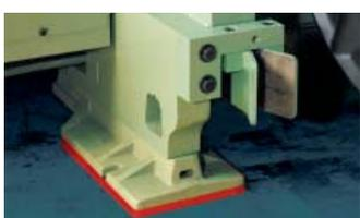
Für Maschinen und Geräte, die „federnd“ gelagert werden müssen, finden auch Gummimetall-Elemente Verwendung. Sie schützen nicht nur schwingungsempfindliche Aggregate und Armaturen (Passiventstörung), sie vermindern auch den Übergang von Maschinenschwingungen auf die Umgebung (Aktiventstörung).
