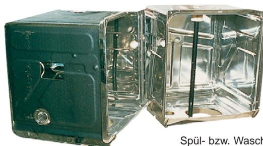
Spül- bzw. Waschmaschinengehäuse werden ebenfalls mit spritz-, streich- oder spachtelbaren Antidröhnmaterialien ausgekleidet.
