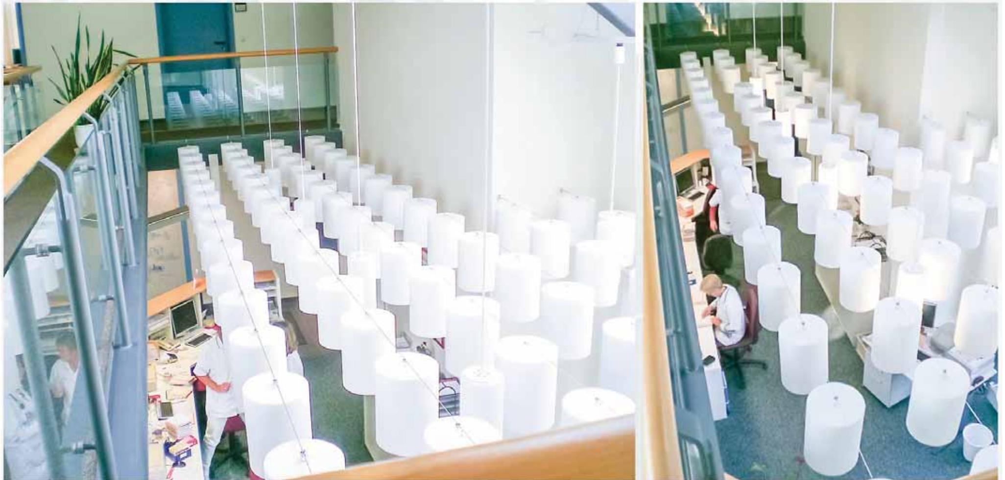
In einer Arztpraxis wurde der Lärm in einem stark frequentierten Empfangsbereich durch den Einsatz von WILLBRANDT Akustik-Zylindern erheblich reduziert. Gewählt wurde eine Aufhängung am Seilsystem. Die ebenfalls abgependelten zylinderförmigen Leuchten korrespondieren mit der Geometrie der Absorber.
