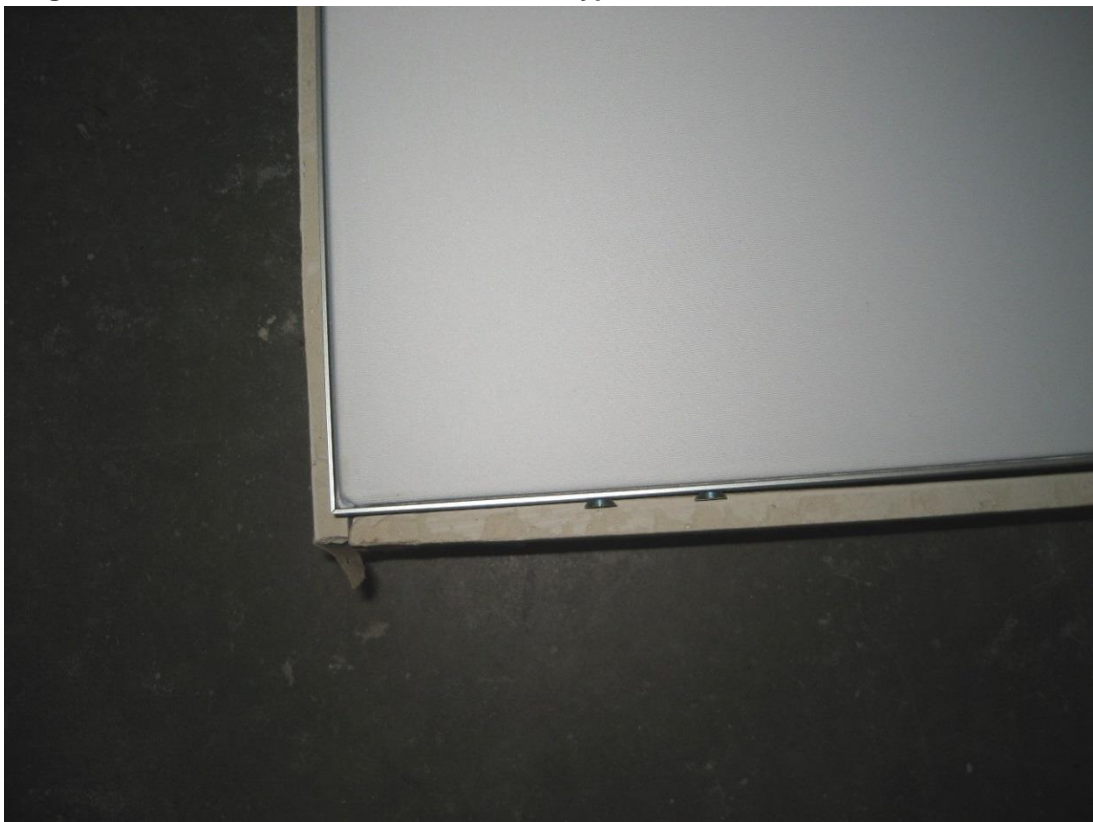
Bild 4: Messung 2, Willbrandt-Akustik-Wandbild 50 mm Typ TK, Hohlraumtiefe 200 mm, Detail
