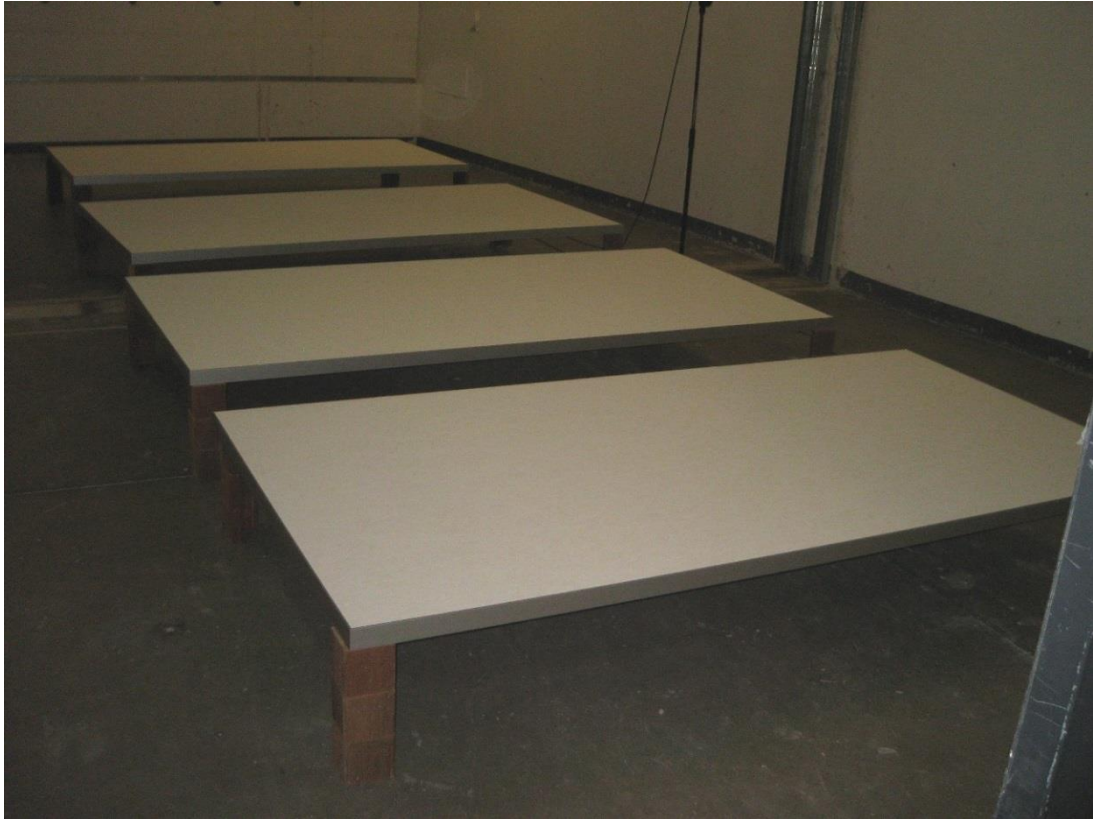
Bild 5: Messung 3 bzw. 6, Willbrandt-Akustik-Deckensegel Typ V, Hohlraumtiefe 300 mm
