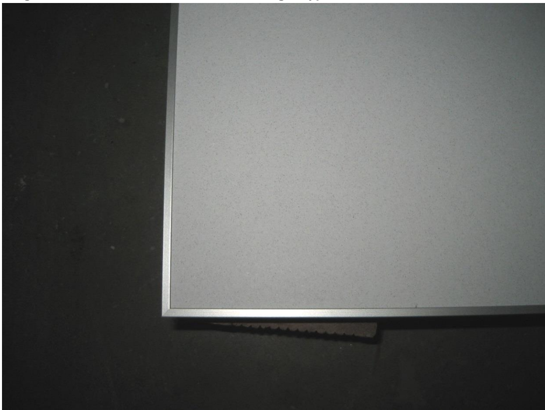
Bild 2: Messung 1 bzw. 4, Willbrandt-Akustik-Deckensegel Typ V, Hohlraumtiefe 100 mm, Detail
