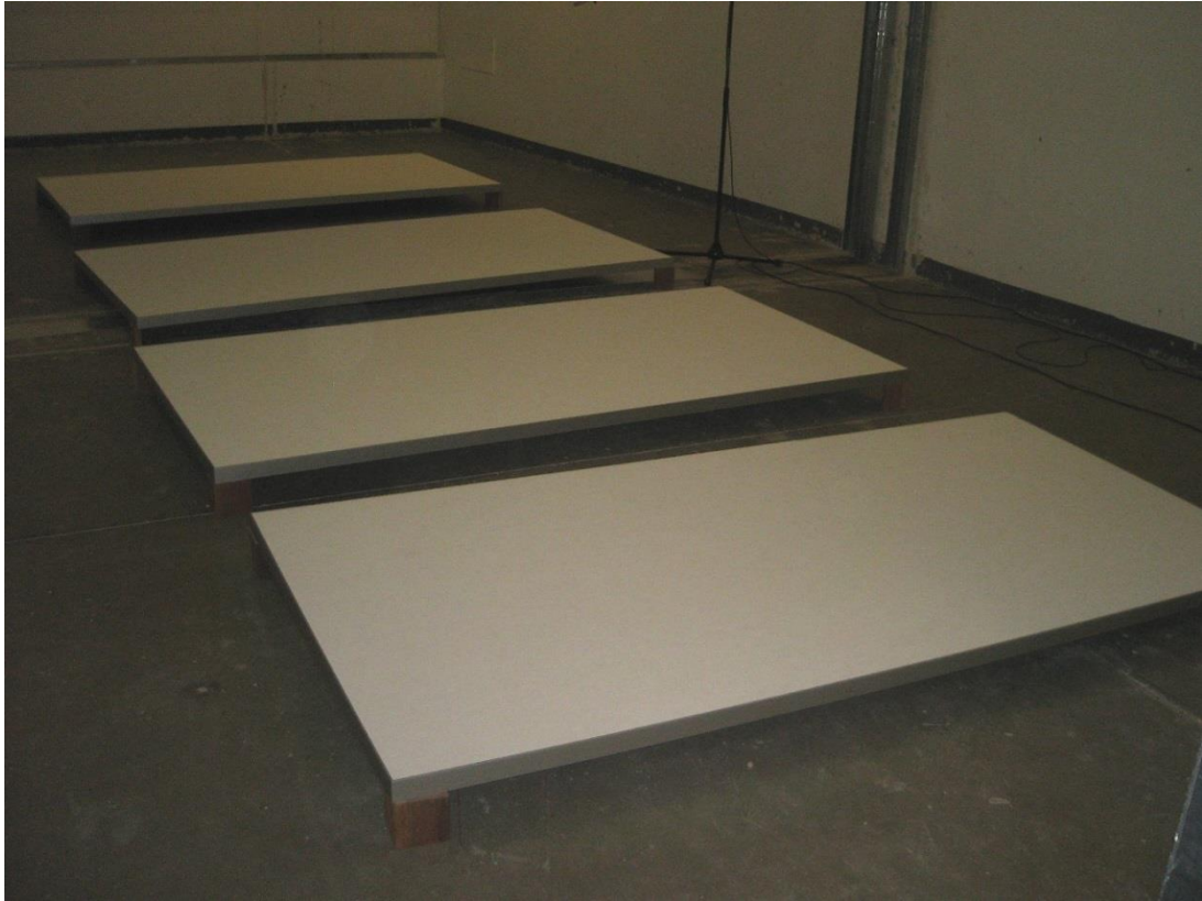
Bild 1: Messung 1 bzw. 4, Willbrandt-Akustik-Deckensegel Typ V, Hohlraumtiefe 100 mm
