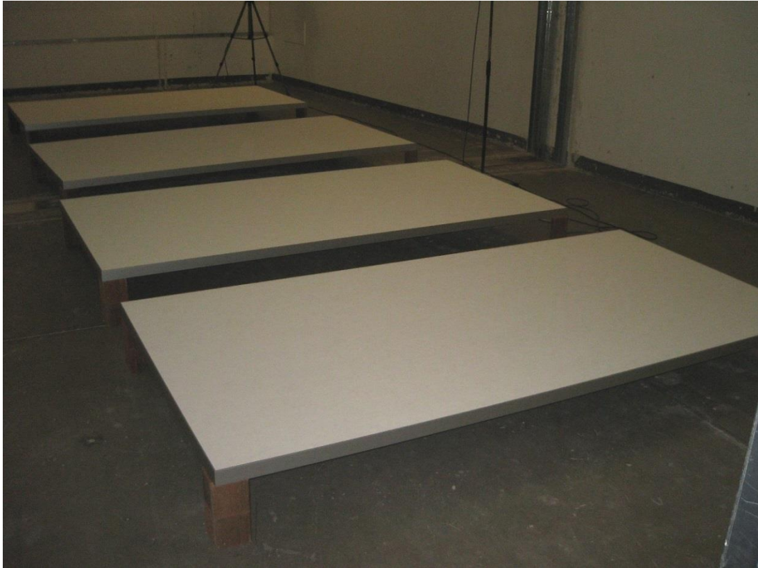
Bild 3: Messung 2 bzw. 5, Willbrandt-Akustik-Deckensegel Typ V, Hohlraumtiefe 200 mm
