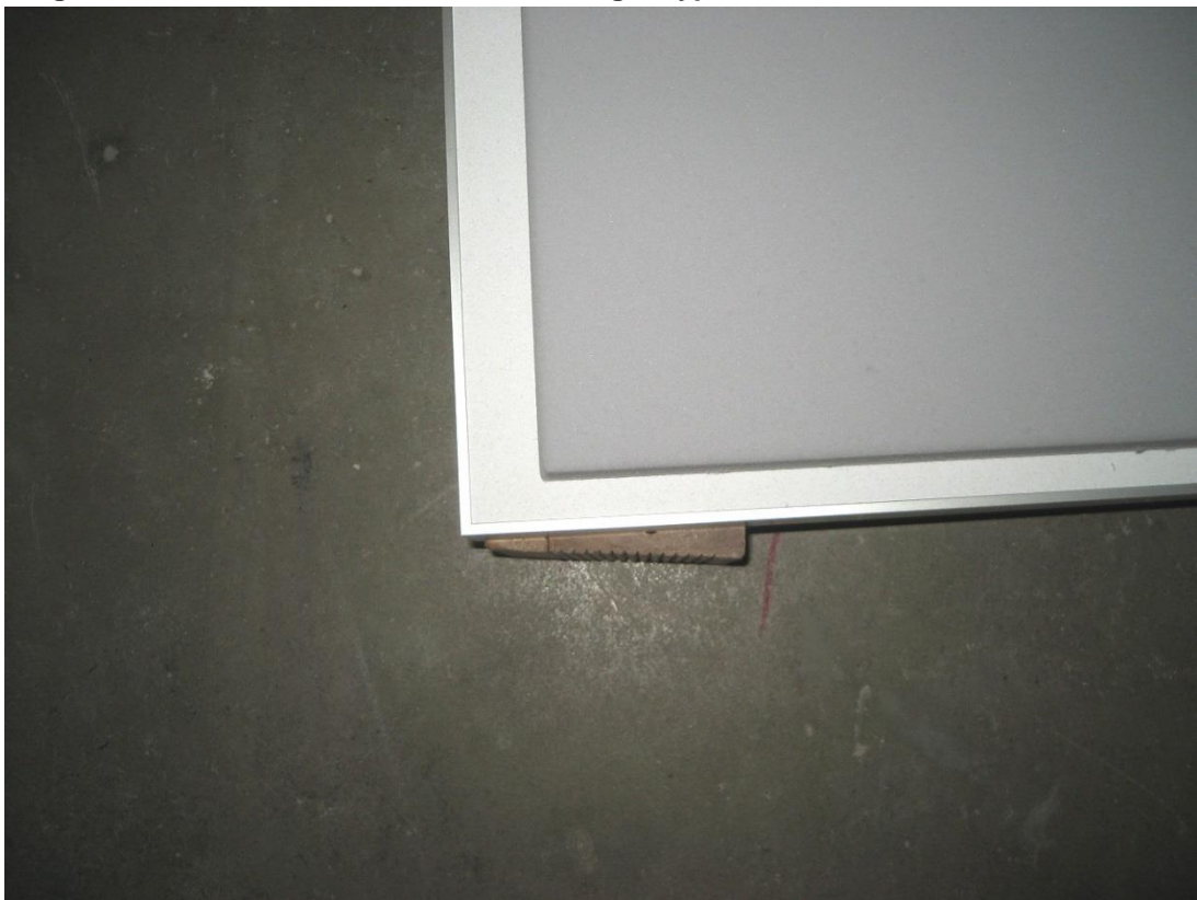
Bild 4: Messung 2 bzw. 5, Willbrandt-Akustik-Deckensegel Typ V, Hohlraumtiefe 200 mm, Detail Rückseite
