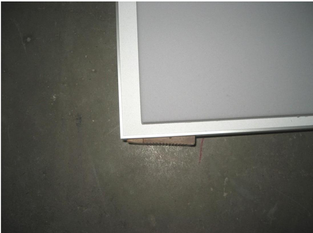
**Bild 5: Messung 3 bzw. 6, Willbrandt-Akustik-Deckensegel Typ V, Hohlraumtiefe 300 mm**
