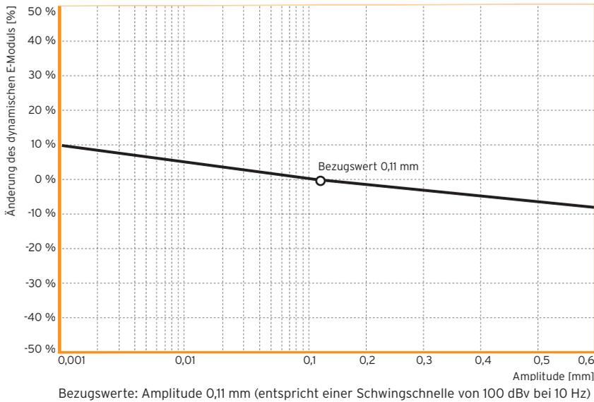
Abb.3: Typischer Verlauf der Abhängigkeit des dynamischen E-Moduls von der Schwingungsamplitude
