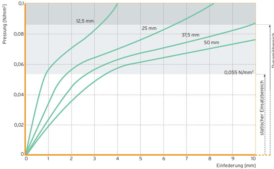
Abb. 1: Quasistatische Federkennlinie mit einer Belastungsgeschwindigkeit von 0,0055 N/mm²/s
