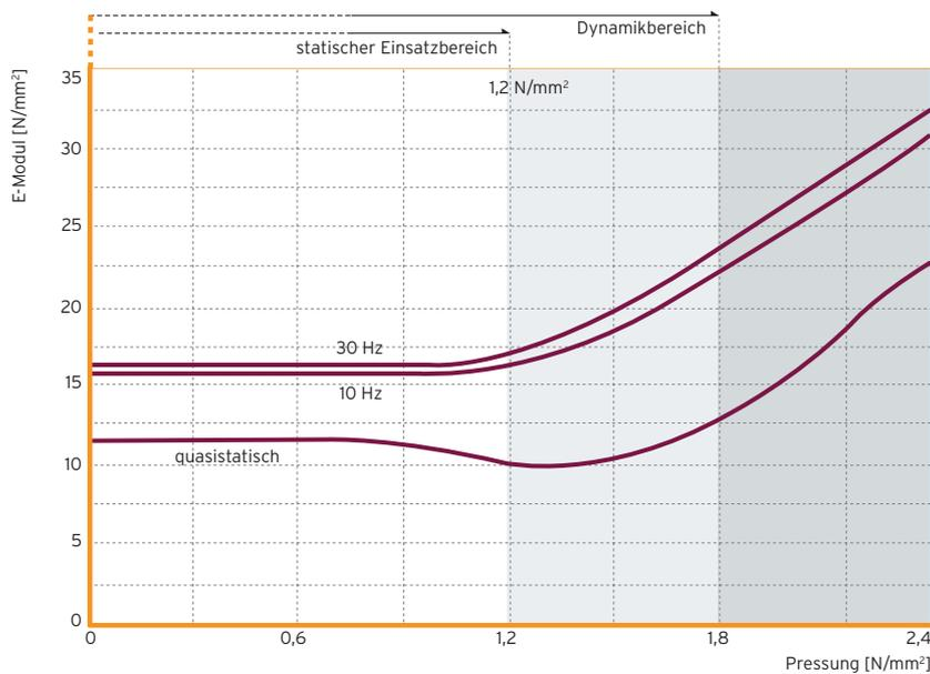
Abb. 2: Belastungsabhängigkeit der statischen und dynamischen E-Moduli
