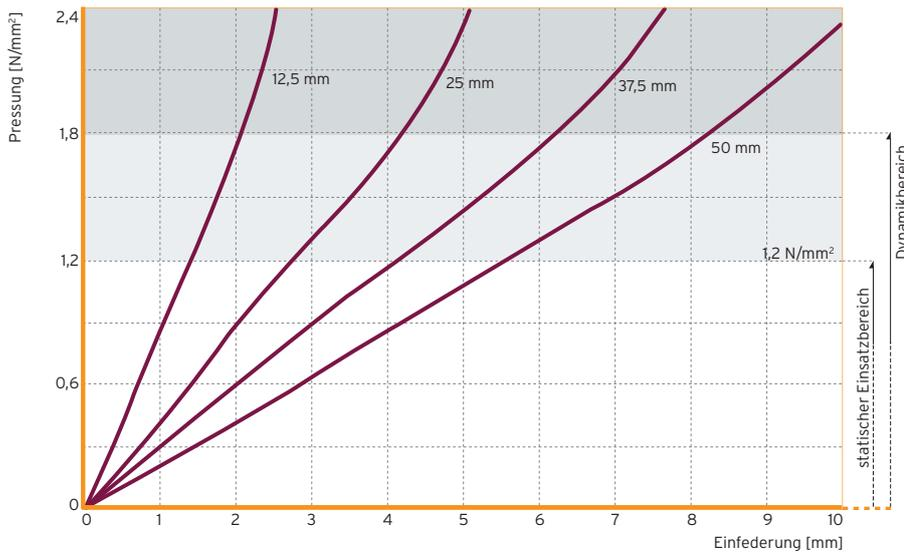
Abb. 1: Quasistatische Federkennlinie mit einer Belastungsgeschwindigkeit von 0,12 N/mm<sup>2</sup>/s
